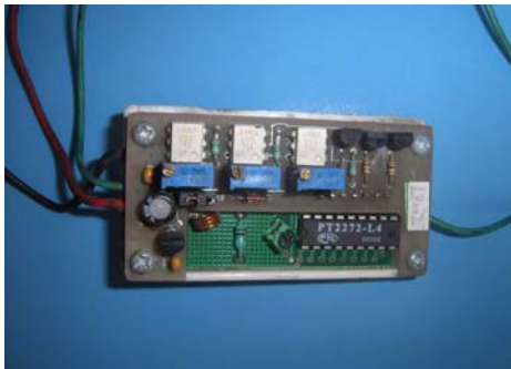
图4 传统的模拟汽车衡作弊工具
