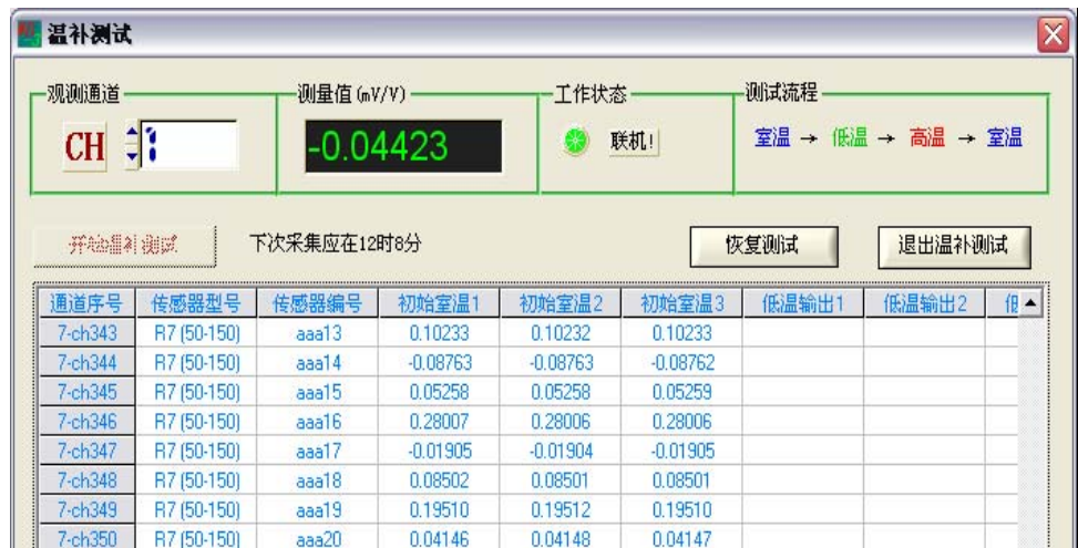
图 3 自动化零点温度补偿数据采集系统界面
