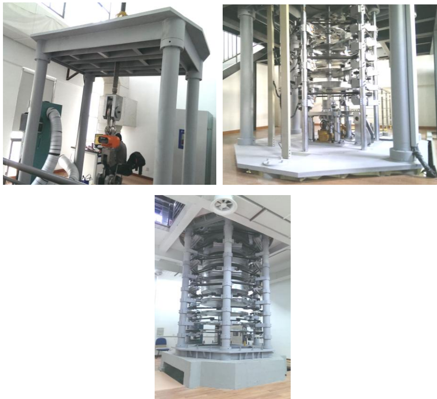
图 8 电子吊秤计量测试装置（顶层工作空间、中间层小砝码组、底层砝码组）
