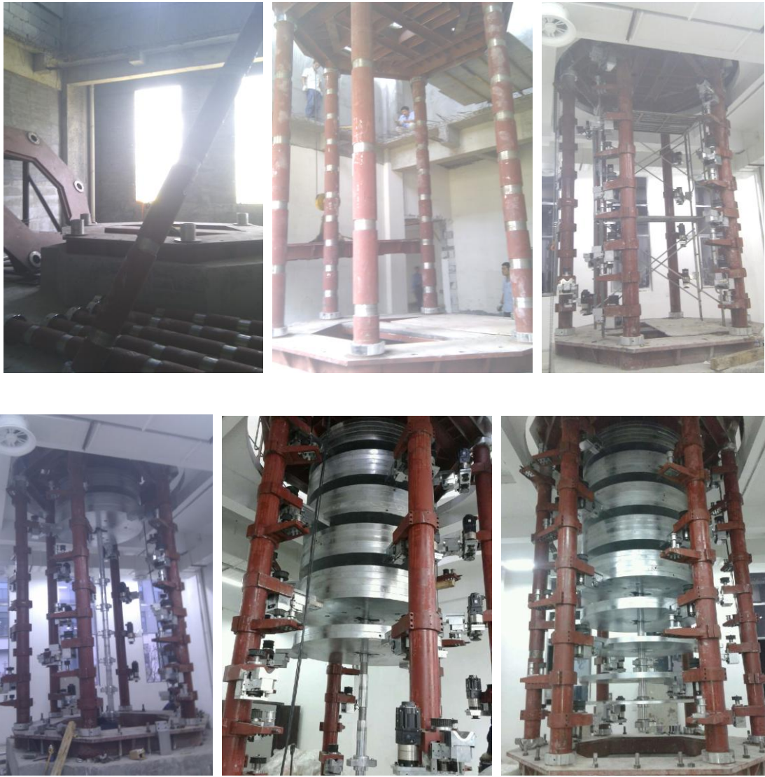
图 7 电子吊秤计量测试装置安装过程
