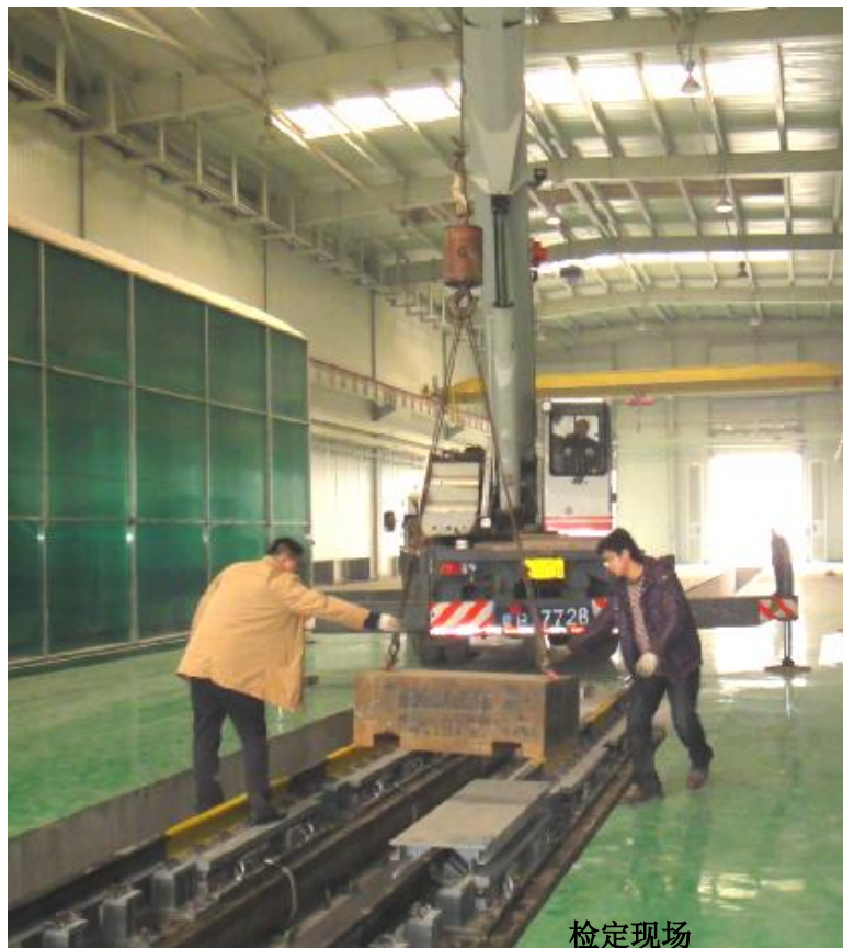
图 9 检定现场砝码加载
