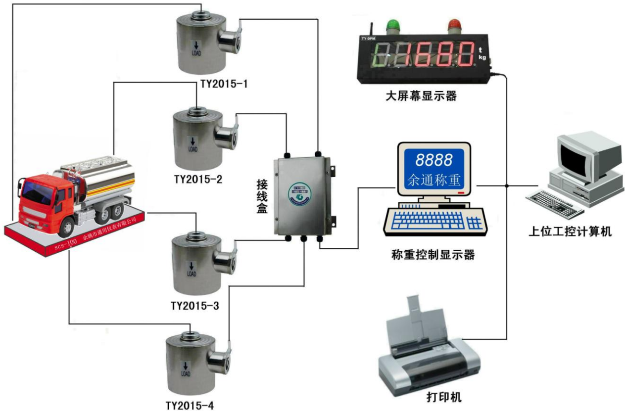
图5 称重系统结构组成与联接
