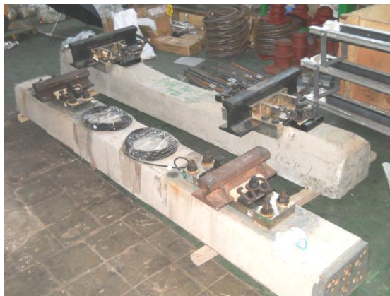
图 7 轨道衡使用的板式传感器
