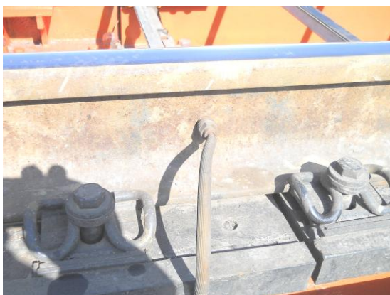
图 6 轨道衡使用的剪力传感器
