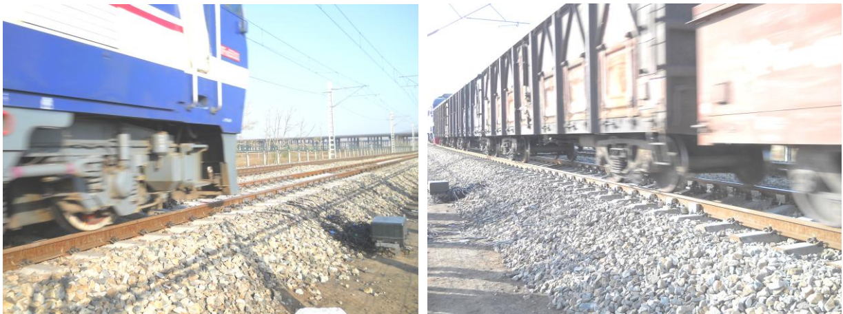
图 1、2 铁道货车超偏载检测装置在 100km/h 速度段适应性检测照片（京包正线） 2014年6月14日；27t 轴重 80t 级通用载重货车专列，在大秦铁路线上顺利运行。
