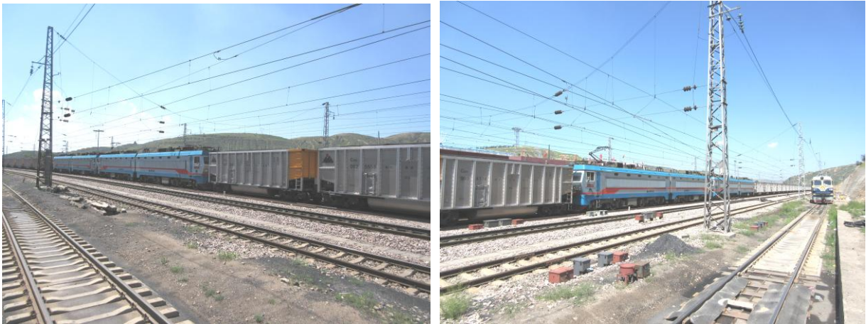
图 3、4 神朔线重载列车中部的牵引机车和 80t 敞车照片
