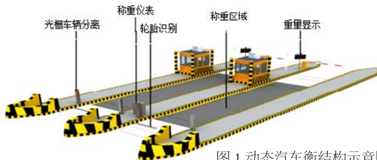
图 1 动态汽车衡结构示意图
