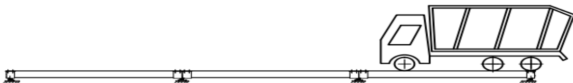
图4 第一个偏载点试验
