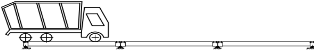
图7 第四个偏载点试验
