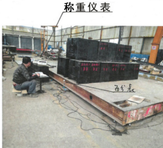
图b 承载器变形测试实际操作图
