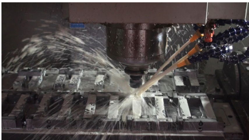
图13 手动翻转卡具加工示例
