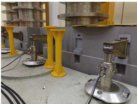
图4 衡器载荷测量仪在质量比较仪上进行校准
