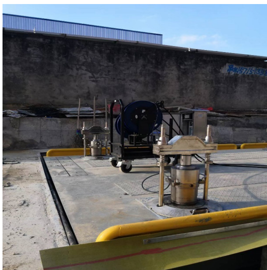
图6 衡器载荷测量仪校准10 t电子衡器
