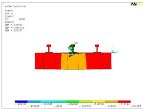
(a) 极限位置 (b) 跨中位置 图 7 工况一 y 向变形侧视图
