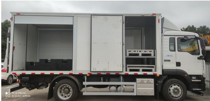
存空间，实现了标准器的模块化组合，既保证了砝码的干净整洁，又提高了砝码的使用效率和运输的安全性。同时，预留了装载叉车的位置，在需要的时候，随车携带自备叉车，可极大地提高该专用检衡车服务不同企业时的现场适应性。另外，对摆放砝码的栈板进行了特殊处理，栈板尺寸依据标准砝码的尺寸进行设计，保证砝码刚好成排摆放，没有过大的摆放间隙，并且加了栈板护栏，以保证砝码运输过程中的安全。栈板材质要求跟高等级砝码相同，同时赋予固定的质量，在必要的时候，直接连同标准砝码一起投入衡器检定，减少人员多次搬运的次数，可有效提高检测效率，这也是基于实践经
