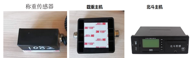
图2 车载智能动态称重装车结构图
