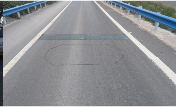
图2 窄条式动态公路车辆自动衡器
