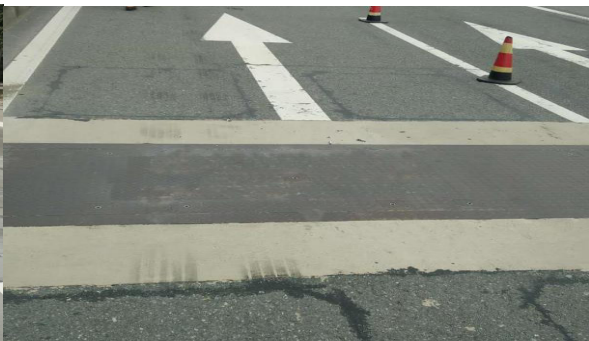
图4 石英晶体式动态公路车辆自动衡器
